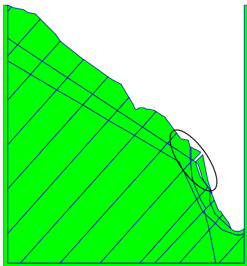
图 6 边坡失稳破坏形态
